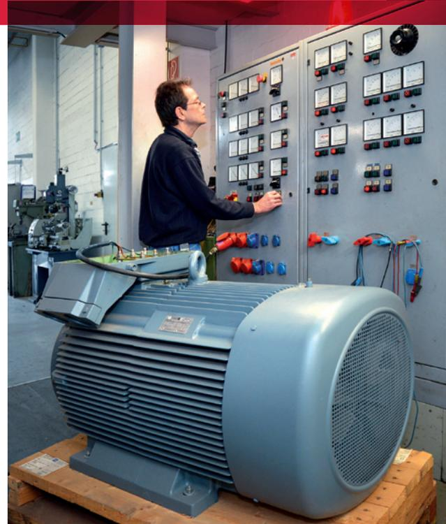
56 bis 400, in allen Bauformen, in fast allen Drehzahlen, polumschaltbare Motoren, explosionsgeschützte Motoren der Klassen Ex e und Ex d bis Baugröße 225, Bremsmotoren und fremdbelüftete Motoren für den Betrieb am Frequenzumrichter.
